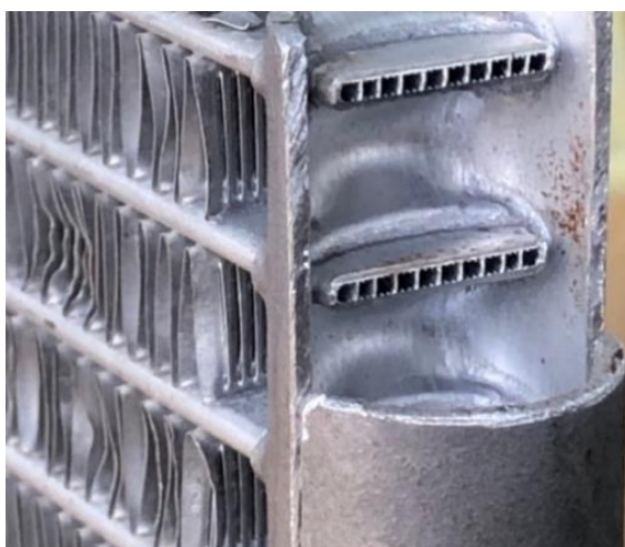
Hình 3. 11 Tiết diện ống góp và kênh micro trên TBBH
