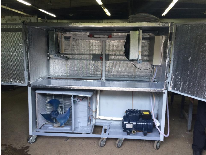
Hình 5. 6 Hệ thống lạnh CO 2 được hoàn thiện
